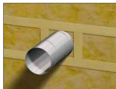
D5. Kubbing rundt gjennomføringer
