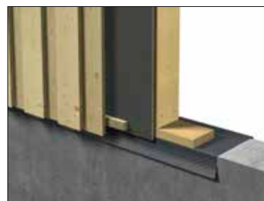
D7. Overgang mur og vegg
